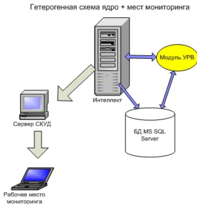
Рис. 4.3—5 Гетерогенная схема «ядро + место мониторинга»
