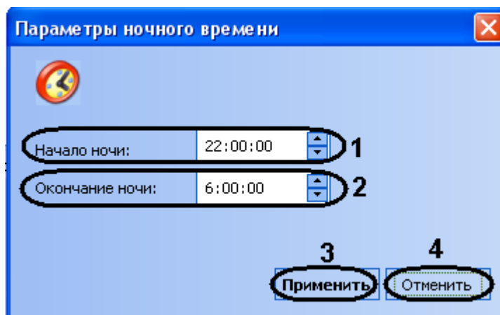
Рис. 5.2—2 Настройка начала и окончания ночи
