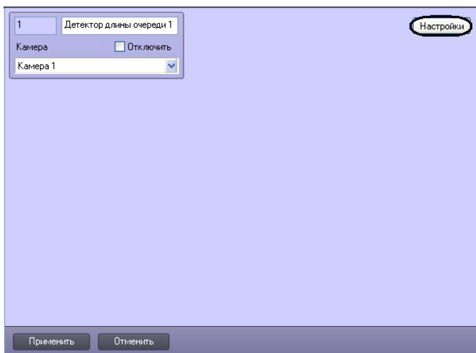
Рис. 6.1—2 Панель настроек объекта Детектор длины очереди
