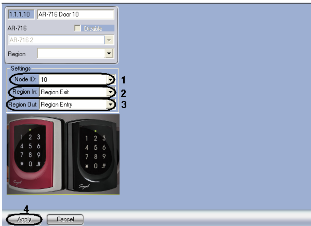
Рис. 2.4—6 Настройка объекта Дверь AR-716
