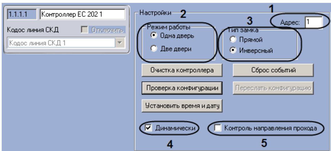
Рис. 3.5—2 Настройка контроллера системы КОДОС
