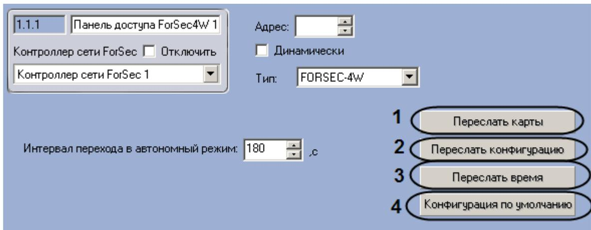
Рис. 3.5—1. Пересылка конфигурации в панель доступа ForSec
