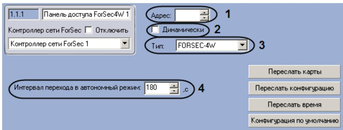
Рис. 3.4—2. Настройка панели доступа ForSec
