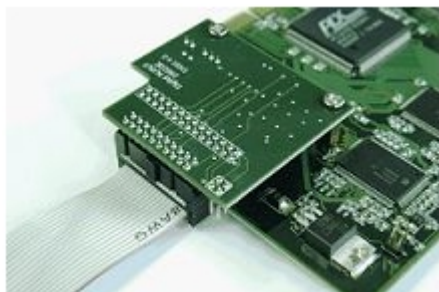
Пример подключения интерфейсного кабеля к плате лучи-реле 4/4
