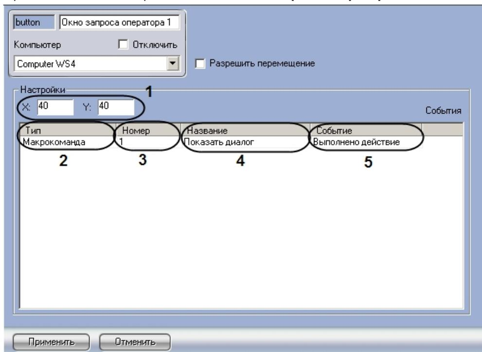
3. Указать координаты окна: в поле **X**: указать координату по горизонтальной оси, в поле **Y**: указать координату по вертикальной оси (1).
