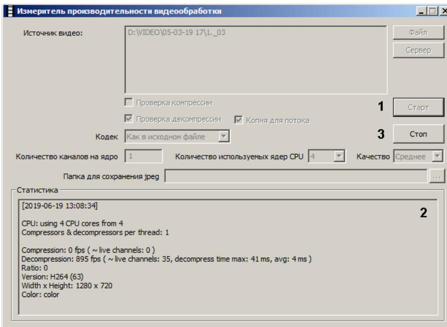
В результате выполнения операции в поле **Статистика** будут отображаться параметры производительности видеообработки (2).
