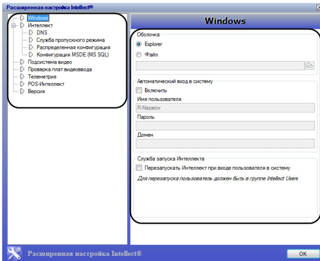
Дерево разделов диалогового окна `tweaki.exe` имеет статичную структуру и предназначено для обеспечения навигации при работе с утилитой. Для доступа к панели настроек требуемого раздела следует произвести щелчок левой кнопкой мыши по соответствующей вкладке дерева.
