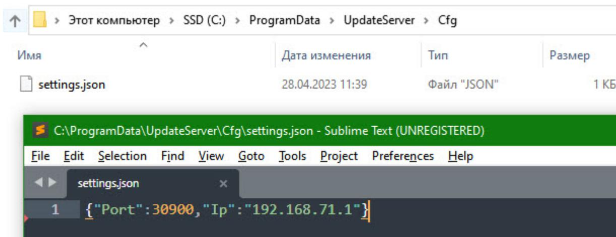
При необходимости IP-адрес и порт **Сервера обновлений** можно поменять вручную, для этого:
