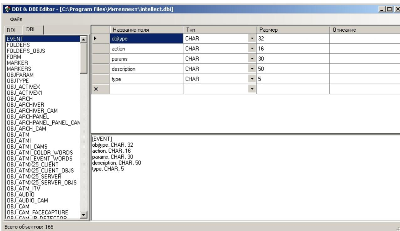
Удаление, добавление и редактирование полей объекта производится посредством таблицы в левой части окна утилиты.
