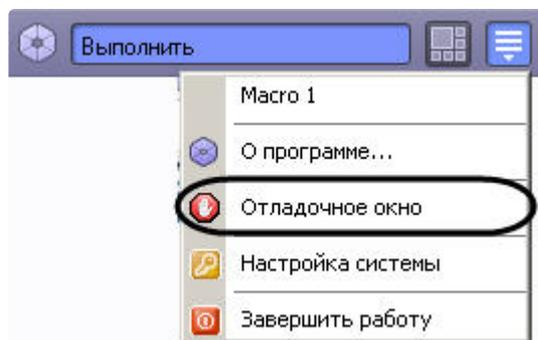
7. Выбрать пункт **Отладочное окно** в Главной панели управления для отображения **Отладочного окна** на экране монитора. Выбранный пункт меню **Отладочное окно** будет отмечен флажком.
