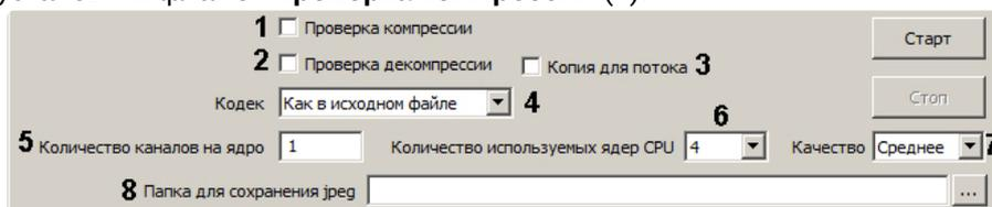
2. Для проверки, сколько кадров в единицу времени может декомпрессировать данный компьютер, установить флажок **Проверка декомпрессии** (2).
