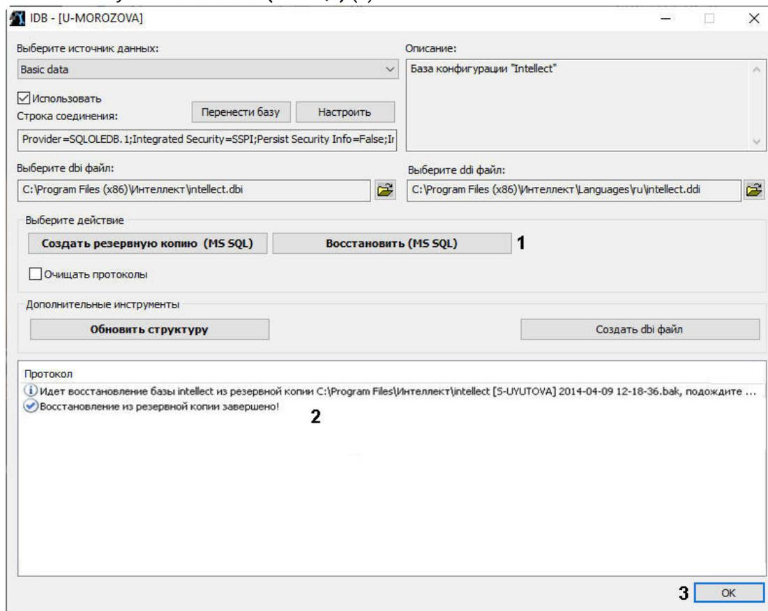
4. При помощи стандартного диалога открытия файлов выбрать созданный ранее файл с резервной копией базы данных.
