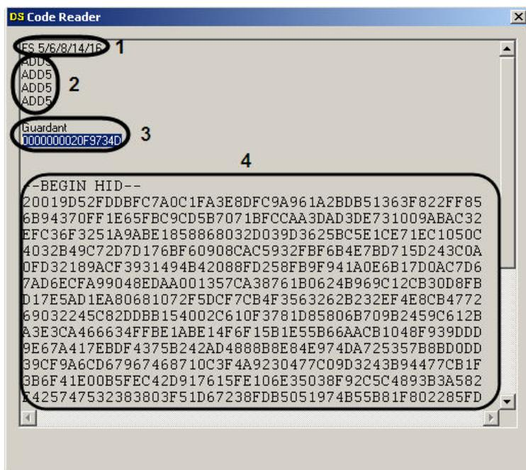
Количество dallas-кодов, определяющихся утилитой, зависит от числа чипов на плате видеоввода. На примере на рисунке видно, что была использована плата видеоввода FS6, которая имеет 4 чипа.
