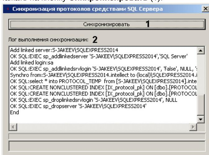
3. В поле **Лог выполнения синхронизации** будет отображаться информация о процессе выполнения синхронизации (2).
