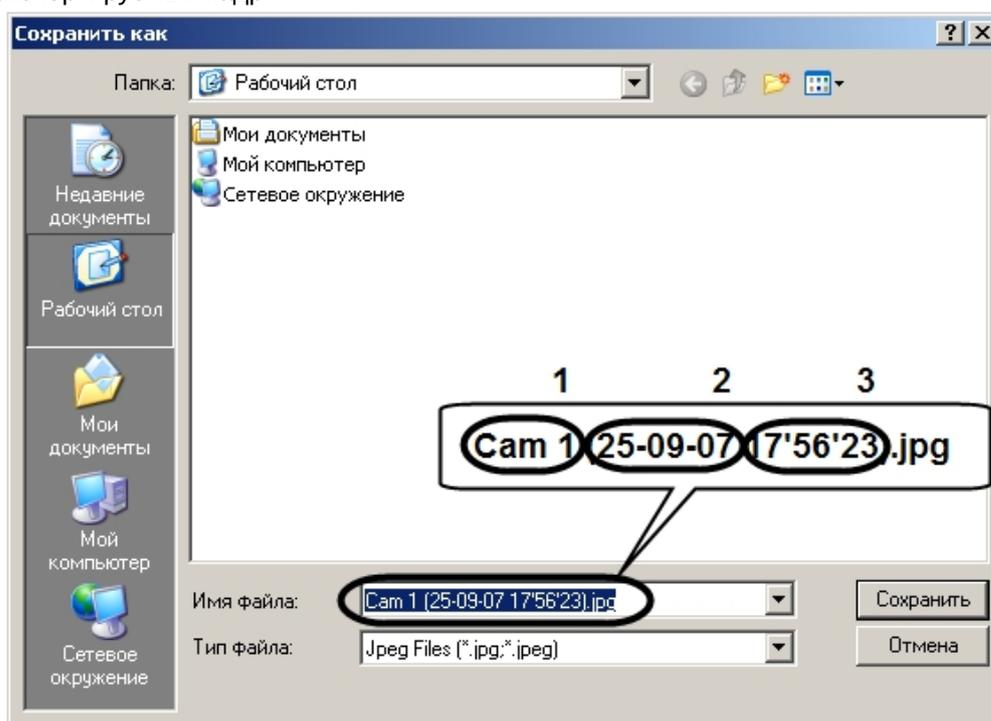
Автоматически имя сохраняемого файла будет сформировано следующим образом: а) название и номер устройства – видеокамеры, с которого был сделан кадр; б) дата и время создания. Расширение файла, в который экспортируется кадр, соответствует формату, выбранному в панели **Настройка экспорта**.
