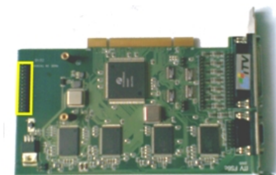
Разъем J9 на плате видеоввода для подключения платы лучи-реле (на примере платы видеоввода FS6)
