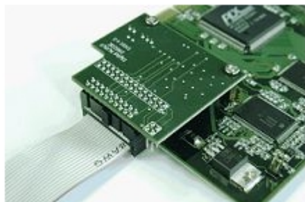
Пример подключения интерфейсного кабеля к плате лучи-реле 4/4
