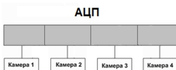
А. равномерное распределение видеокамер между АЦП
