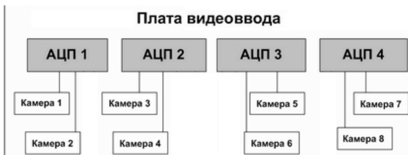
А. равномерное распределение видеокамер между АЦП
