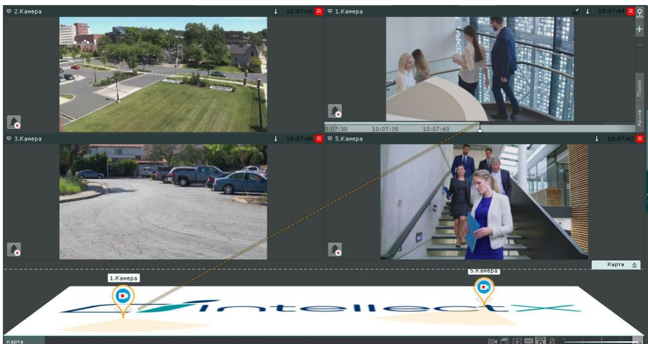
На карте могут располагаться значки видеокамер, реле и датчиков. Для каждой видеокамеры отображается сектор её обзора и область, в которой отображается видеонаблюдение в реальном времени.
