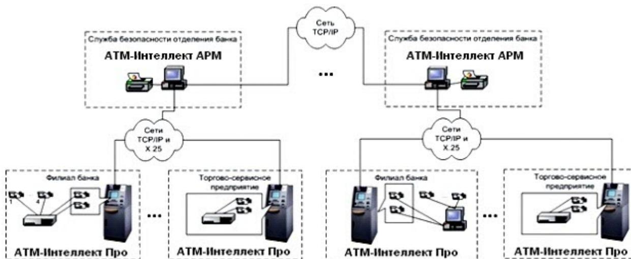
*АТМ-Интеллект Про* размещаются непосредственно на месте установки банкоматов в филиалах банка или торгово-сервисных предприятиях. *АТМ-Интеллект Про* обеспечивают запись видеоинформации, поступающей с видеокamer, в локальный видеоархив, обработку сигналов с дискретных датчиков, установленных на банкомате, и передачу «тревожных» сообщений на *АТМ-Интеллект АРМ*.
