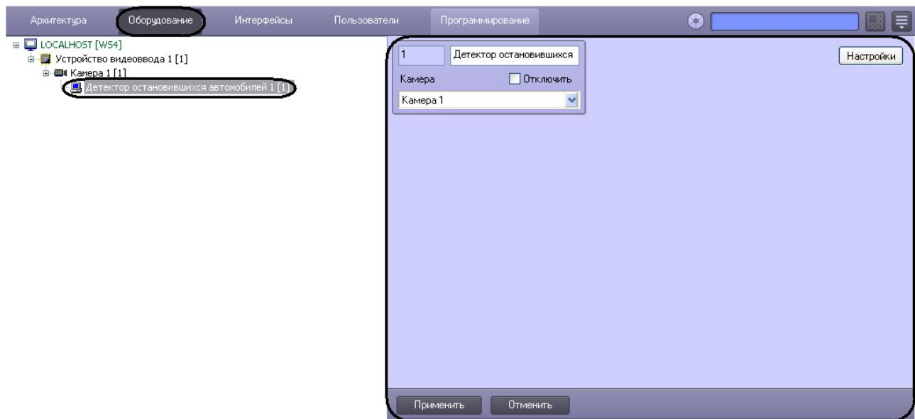
Настройка программного модуля *Детектор остановившихся автомобилей* осуществляется следующим образом:
