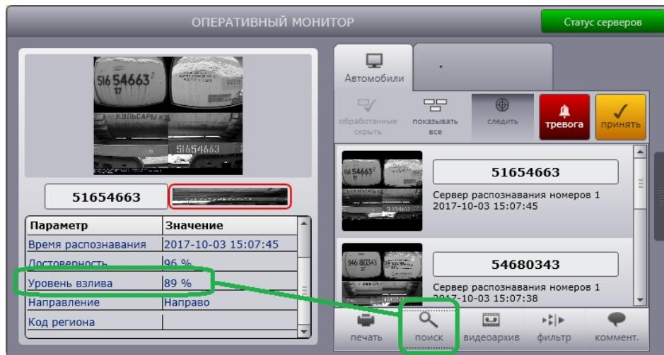
Также модуль **Детектор уровня взлива** выводит информацию об уровне взлива в виде титров на видеоизображение в Окне видеонаблюдения соответствующей видеокамеры на Мониторе видеонаблюдения.
