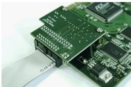
Пример подключения интерфейсного кабеля к плате лучи-реле 4/4
