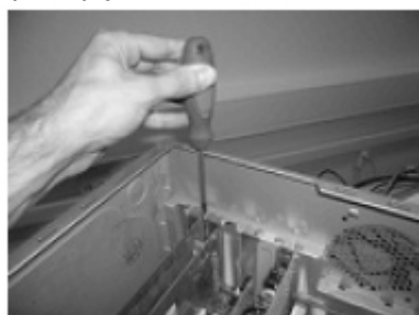
Пример установки платы видеоввода FS-6C в PCI слот
