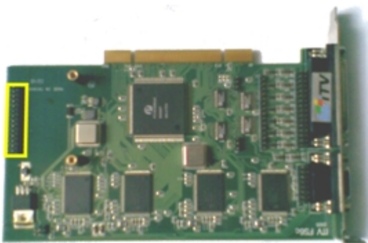
Разъем J9 на плате видеоввода для подключения платы лучи-реле (на примере платы видеоввода FS6)
