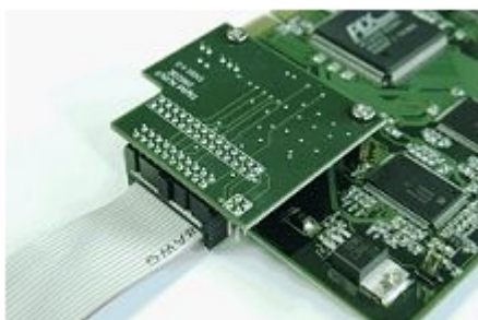
Пример подключения интерфейсного кабеля к плате лучи-реле 4/4
