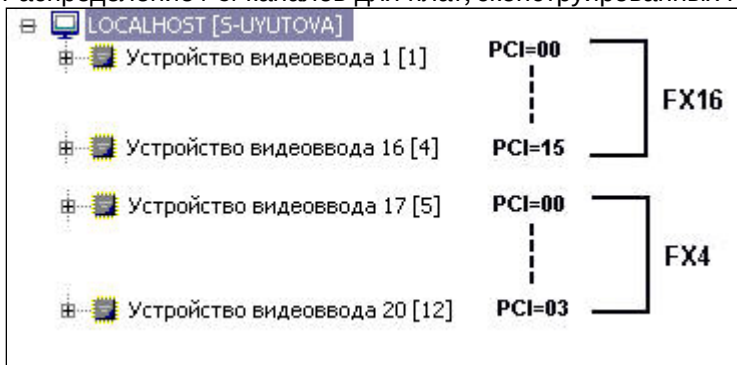
Распределение PCI-каналов для плат, сконструированных на разных моделях чипа (АЦП)
