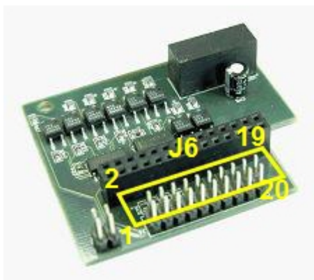
Разъемы на плате лучи-реле для подключения интерфейсного кабеля (на примере плат лучи-реле 4/4 и 16/4)
