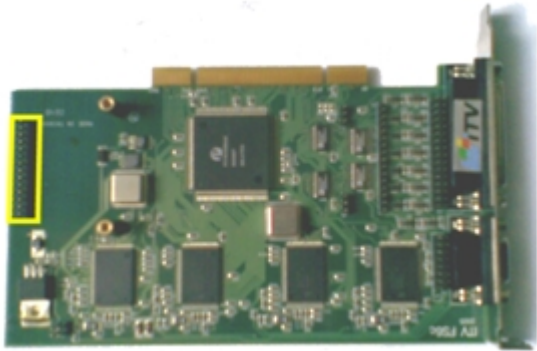
Разъем на плате видеоввода для подключения платы лучи-реле (на примере платы видеоввода FS6)
