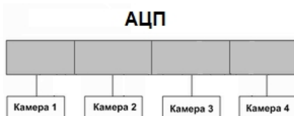
А. равномерное распределение видеокамер между АЦП
