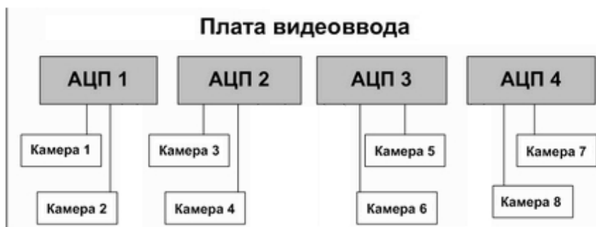
А. равномерное распределение видеокамер между АЦП
