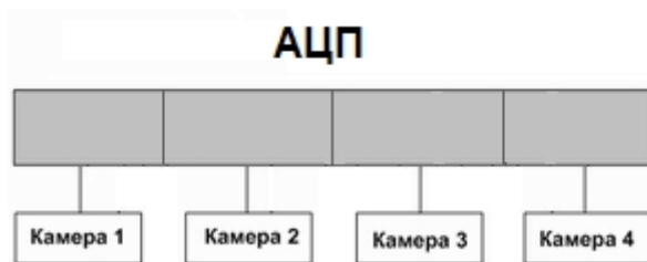
А. равномерное распределение видеокамер между АЦП
