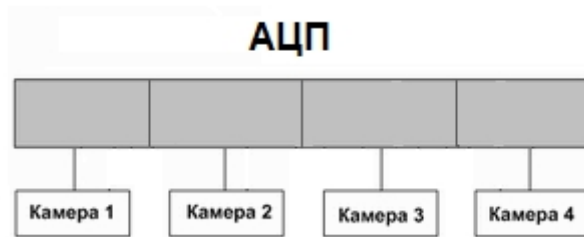
А. равномерное распределение видеокамер между АЦП
