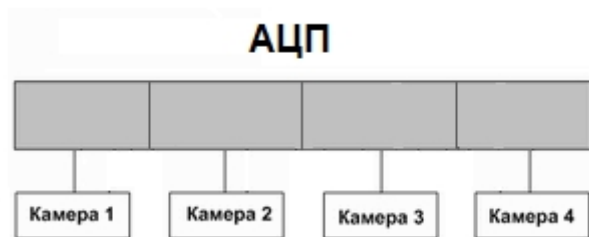
А. равномерное распределение видеокамер между АЦП
