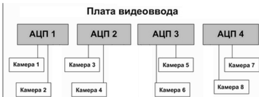
А. равномерное распределение видеокамер между АЦП
