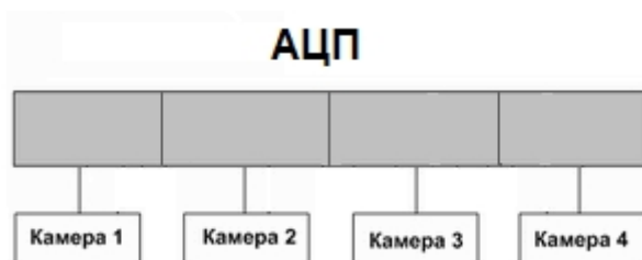
А. равномерное распределение видеокамер между АЦП
