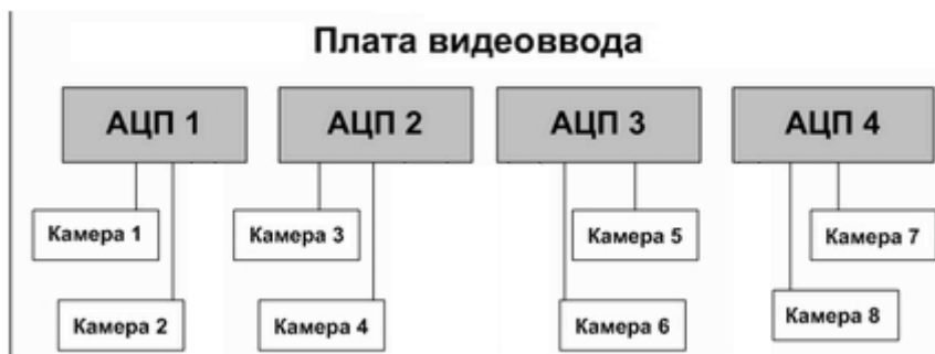
А. равномерное распределение видеокамер между АЦП
