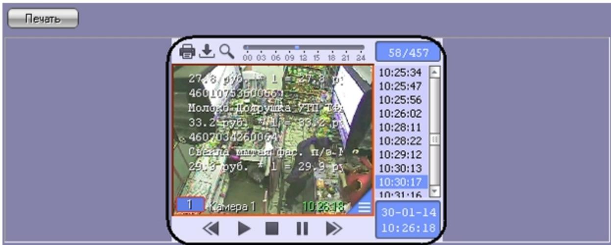
В данном окне доступны функции обработки и экспорта, аналогичные таковым в Мониторе видеонаблюдения. В частности, имеется возможность осуществлять экспорт роликов вместе с наложенными титрами. Подробнее об использовании функций Монитора видеонаблюдения см. *Программный комплекс Интеллект. Руководство Оператора* (наиболее актуальная версия данного документа доступна в хранилище документации *AxxonSoft documentation repository*).
