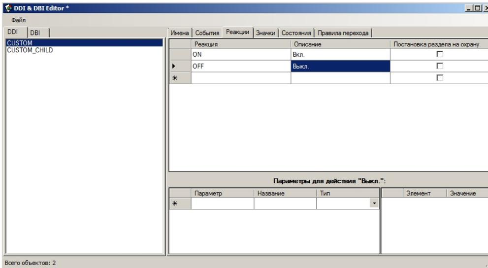
5. Перейти на вкладку **Состояния** и описать состояния, которые может принимать объект. В данном примере рассмотрено два состояния – ON и OFF.
