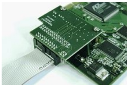
Пример подключения интерфейсного кабеля к плате лучи-реле 4/4
