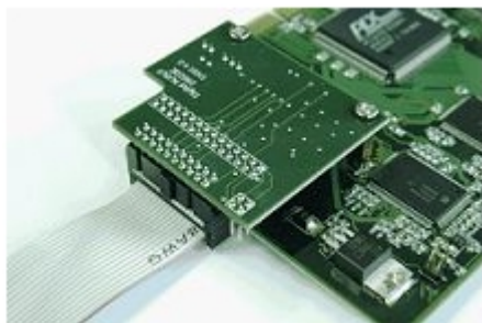
Пример подключения интерфейсного кабеля к плате лучи-реле 4/4
