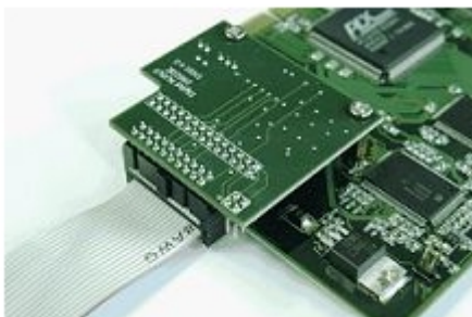
Пример подключения интерфейсного кабеля к плате лучи-реле 4/4
