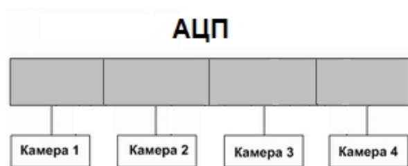
А. равномерное распределение видеокамер между АЦП
