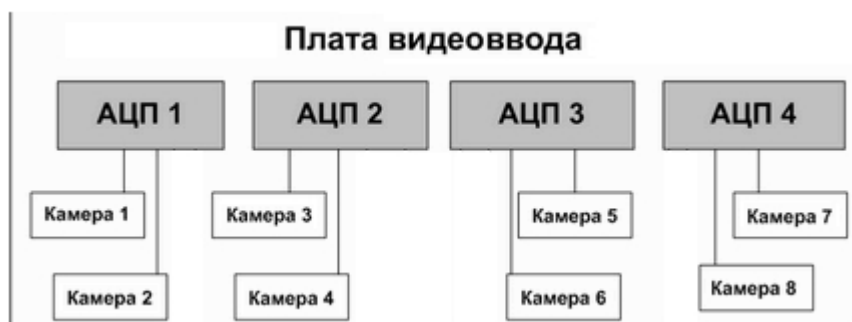
А. равномерное распределение видеокамер между АЦП
