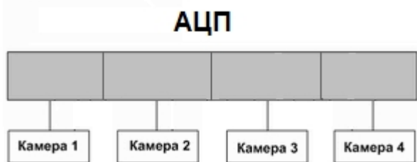
А. равномерное распределение видеокамер между АЦП
