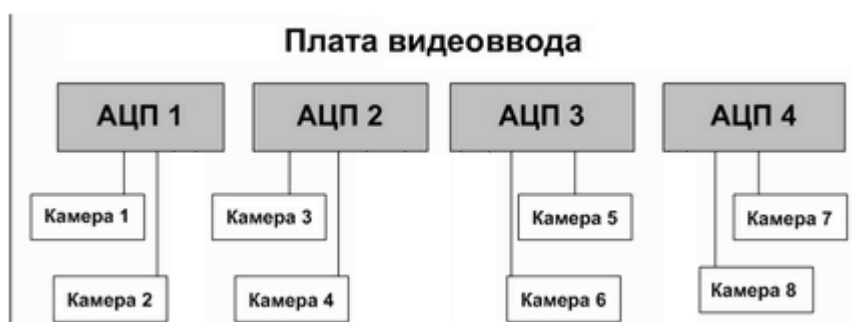
А. равномерное распределение видеокамер между АЦП
