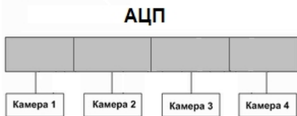
А. равномерное распределение видеокамер между АЦП
