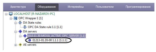
Добавление элемента ОРС-сервера вручную завершено.
