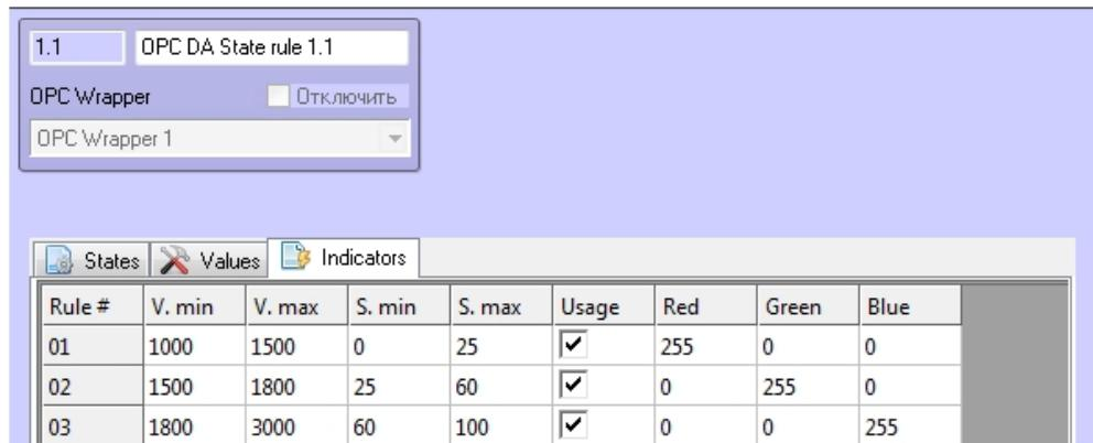
Задано 3 интервала значений элемента, в зависимости от которых индикатор принимает определенное пропорциональное значение и цвет. Расчет точного значения индикатора проводится по следующей формуле:
