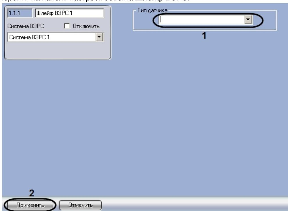
2. Из раскрывающегося списка **Тип датчика** выбрать тип установленного на шлейфе датчика (**1**).
