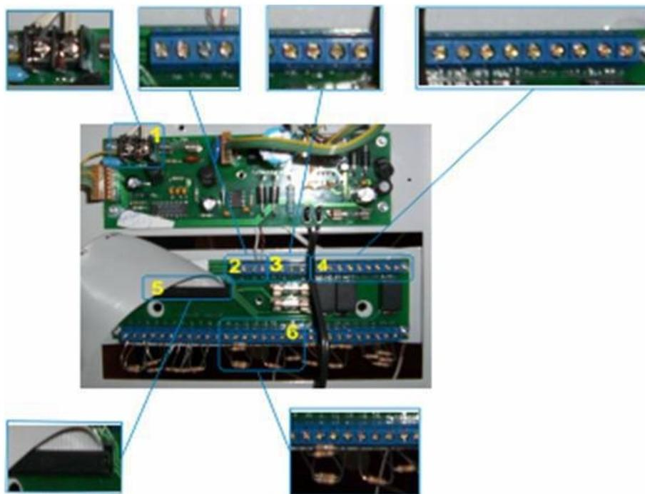
На рисунке показана плата прибора ВЭРС-ПК24мм, на ней цветом выделены клеммы и шлейфы подключений:
