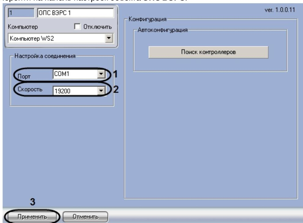
2. Из раскрывающегося списка **Порт** выбрать COM-порт подключения *ОПС ВЭРС-ПКМ24мм* (1).
