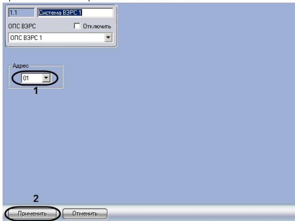
2. Из раскрывающегося списка **Адрес** выбрать аппаратный адрес подключенного прибора (1). Данный адрес может быть установлен при автоматическом построении дерева объектов. В таком случае не рекомендуется менять значение в данном поле.
