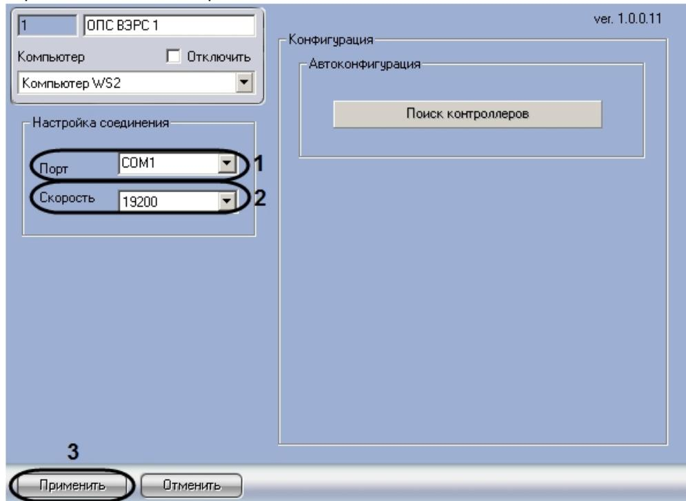
2. Из раскрывающегося списка **Порт** выбрать СОМ-порт подключения **ОПС ВЭРС-ПК24ММ** (1).
