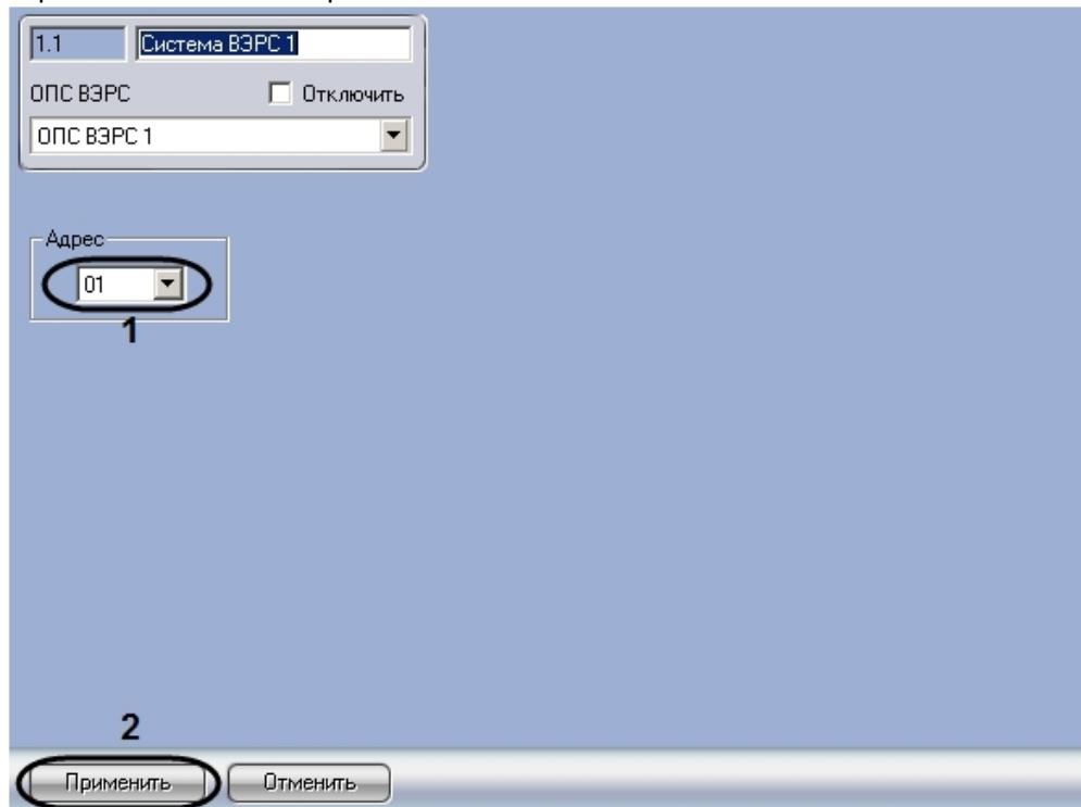
2. Из раскрывающегося списка **Адрес** выбрать аппаратный адрес подключенного прибора (1).
