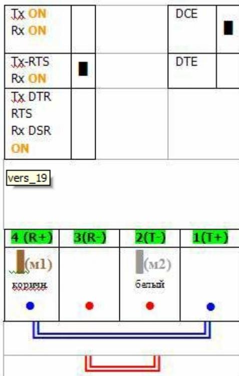
R+ клемма конвертера подключается к M1 клемме прибора, T- клемма подключается к клемме M2 прибора. Положение переключателей и клемм конвертера показано на схеме, двойной красной линией. Синей линией показано расположение перемычек.
