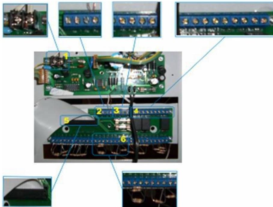
На рисунке показана плата прибора ВЭРС-ПК24мм, на ней цветом выделены клеммы и шлейфы подключений:
