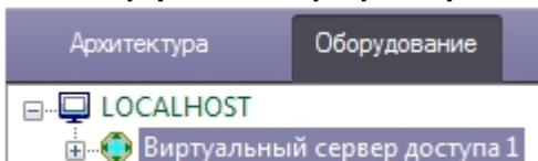
2. На базе объекта **Виртуальный сервер доступа** создать объект **Точка прохода FACE**.
