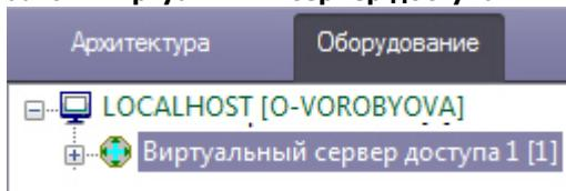
2. На базе объекта **Виртуальный сервер доступа** создать объект **Точка прохода AUTO**.
