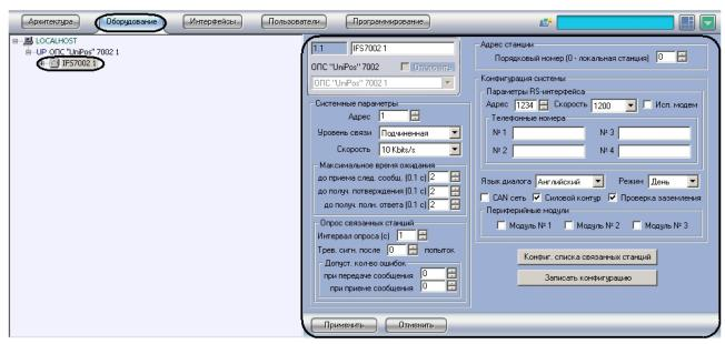
Создание и настройка объектов IFS7002 производится автоматически в результате чтения конфигурации ОПС Unipos (см. раздел Задание параметров системы ОПС Unipos). Существует возможность изменять настройки станции IFS7002 на панели настройки одноименного объекта.
