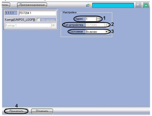
2. В поле **Адрес** ввести с помощью кнопок **вверх-вниз** адрес сирены *FD7204* в CAN-сети *OПC Unipos* (1).
