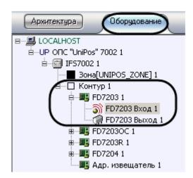
Настройка входов и выходов адресного модуля *FD7203* производится на панели настройки объектов **FD7203** Вход и **FD7203** Выход соответственно. Данные объекты регистрируются на базе объекта FD7203.
