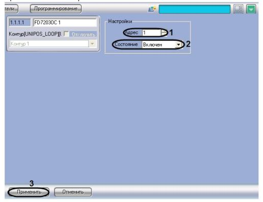
2. В поле **Адрес** ввести с помощью кнопок **вверх-вниз** адрес модуля *FD7203OC* в CAN-сети *OПC Unipos* (1).
