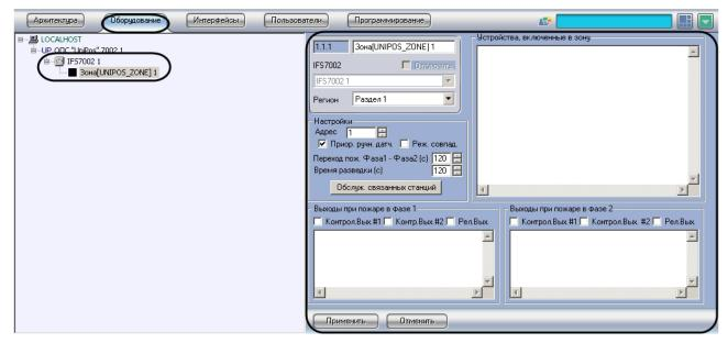
Регистрация и настройка объектов Зона производится автоматически в результате чтения конфигурации ОПС Unipos (см. раздел Задание параметров системы ОПС Unipos). Существует возможность изменять настройки пожароизвещательных зон на панелях настройки данных объектов, а также регистрировать новые пожароизвещательные зоны.
