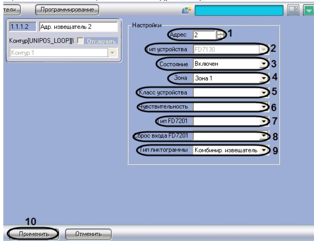
2. В поле **Адрес** ввести с помощью кнопок **вверх-вниз** адрес извещателя в CAN-сети *ОПС Unipos* (1).
