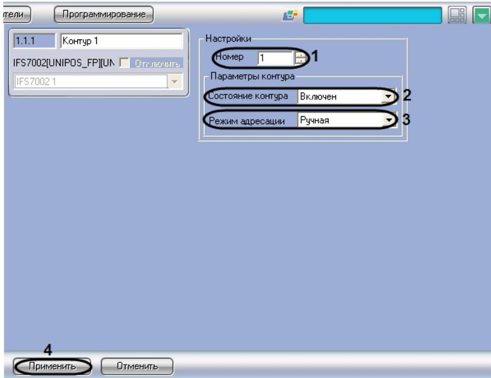
2. В поле **Номер** ввести с помощью кнопок **вверх-вниз** номер (1 или 2) пожароизвещательного контура (1).
