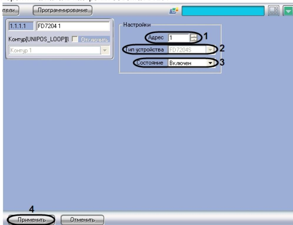
2. В поле **Адрес** ввести с помощью кнопок **вверх-вниз** адрес сирены *FD7204* в CAN-сети *ОПС Unipos* (1).
