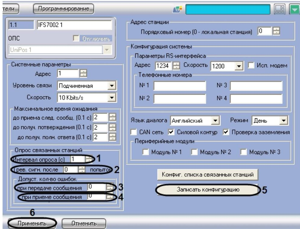
2. В поле со списком **Интервал опроса (с)** ввести интервал времени между двумя последовательными проверками станцией CAN-соединений со связанными станциями. Параметр измеряется в секундах (1)
