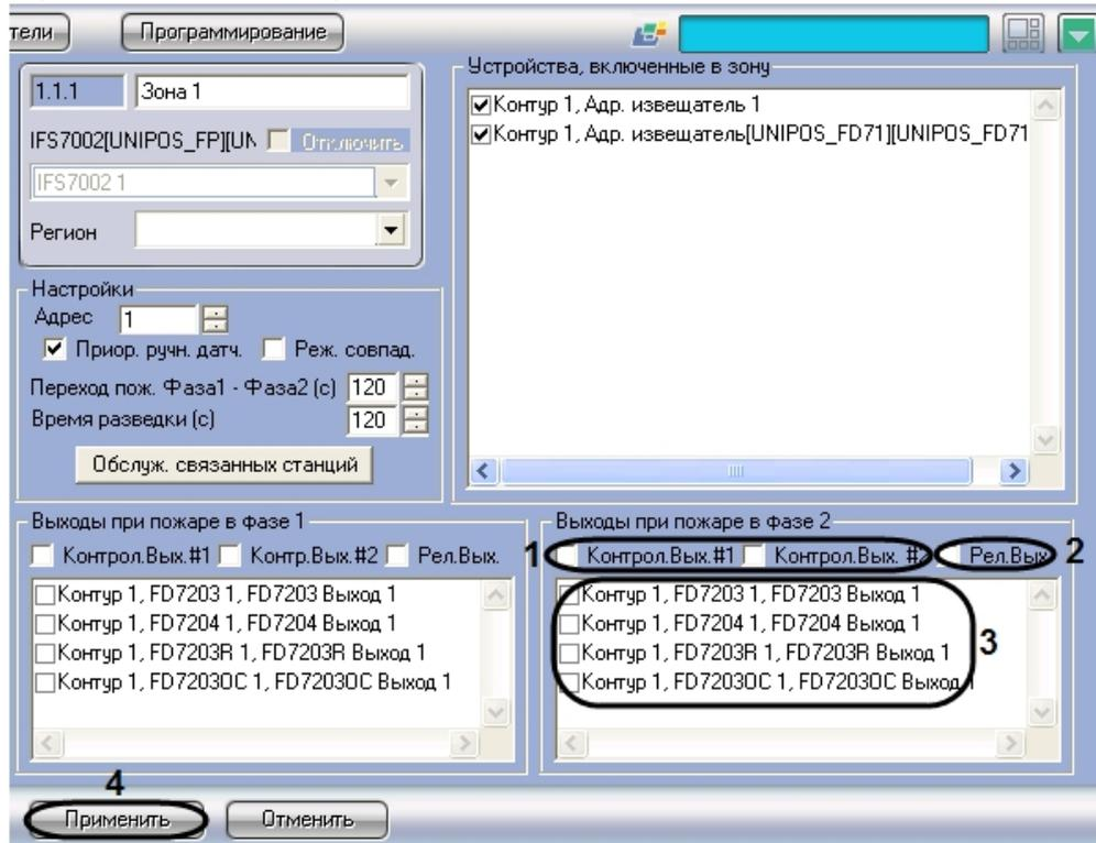
2. В случае, если при пожаре второй степени требуется задействовать исполнительные устройства, подключенные к контрольным выходам станции *ИФС7002*, установить флажки напротив требуемых контрольных выходов (**1**).
