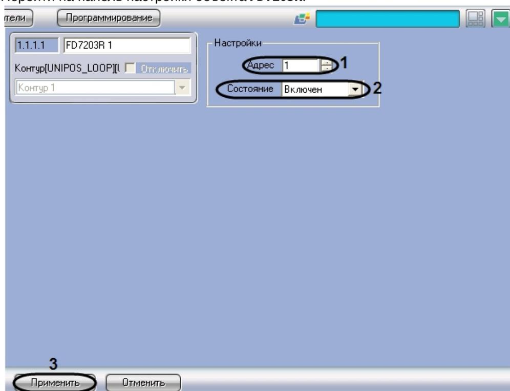
2. В поле **Адрес** ввести с помощью кнопок **вверх-вниз** адрес модуля *FD7203R* в CAN-сети *ОПС Unipos* (1).
