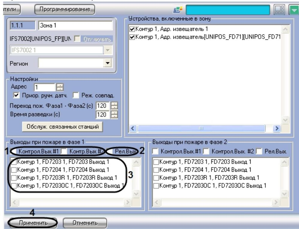
2. В случае, если при пожаре первой степени требуется задействовать исполнительные устройства, подключенные к контрольным выходам станции *IFS7002*, установить флажки напротив требуемых контрольных выходов (1).
