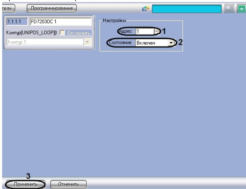
2. В поле **Адрес** ввести с помощью кнопок **вверх-вниз** адрес модуля *FD7203OC* в CAN-сети *ОПС Unipos* (1).
