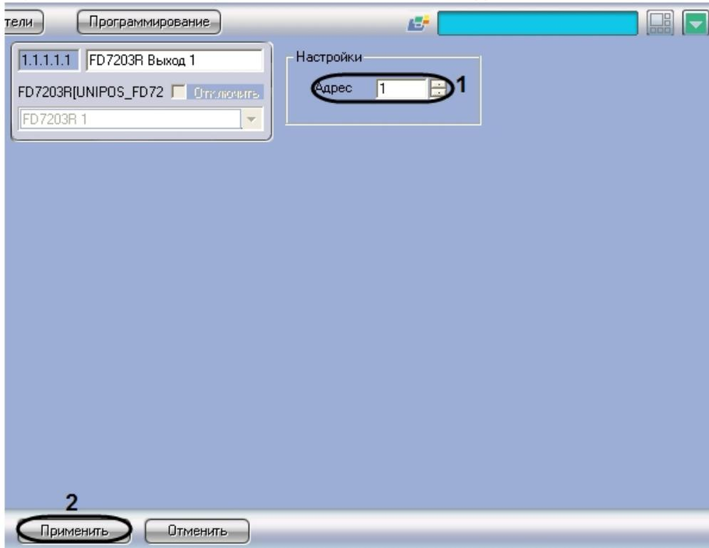
2. В поле со списком **Адрес** ввести адрес выхода модуля *FD7203R* (**1**).
