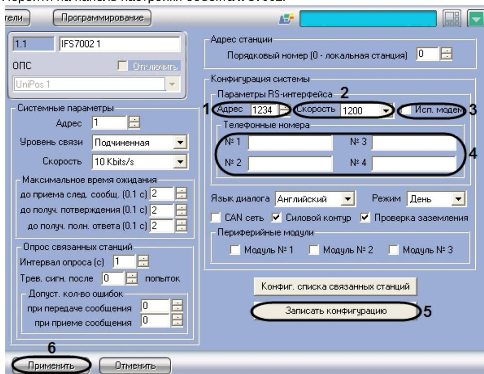
2. В поле **Адрес** ввести с помощью кнопок **вверх-вниз** адрес станции в RS-сети (от 0 до 9999) (1).
