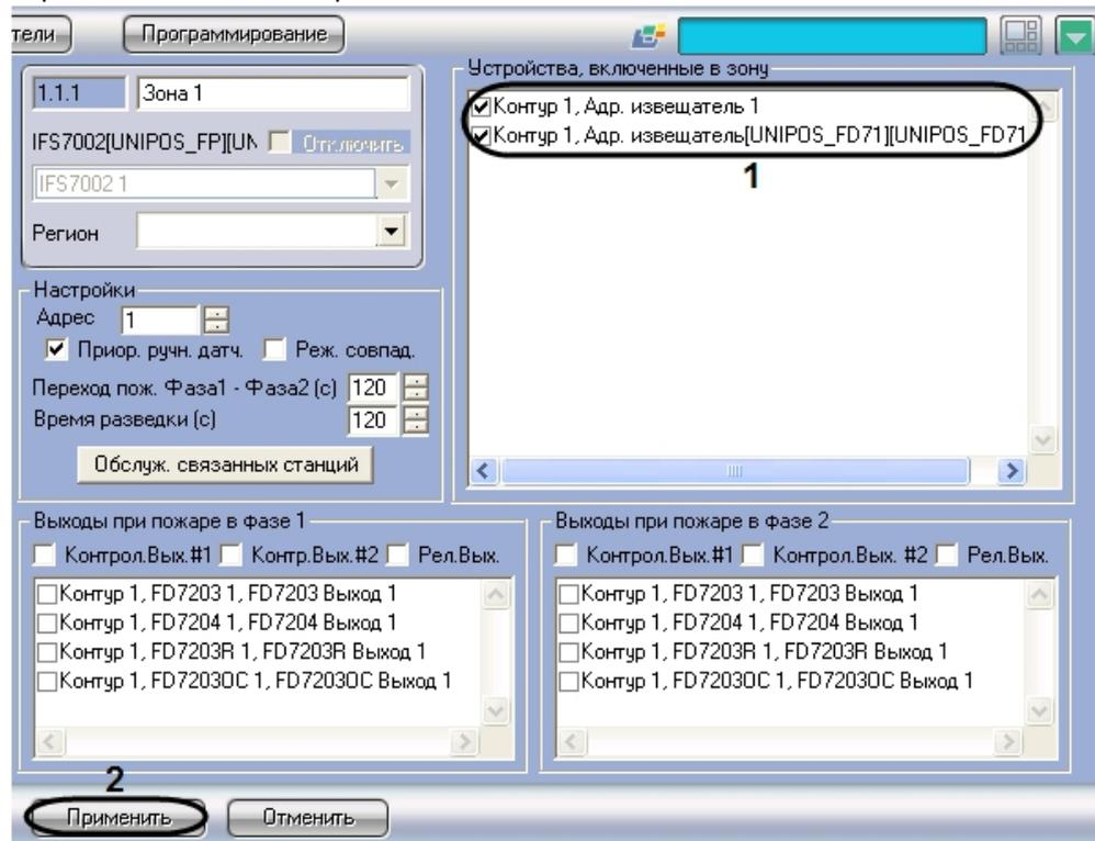
2. В группе **Устройства, включенные в зону** установить флажки напротив требуемых адресных извещателей (1).
