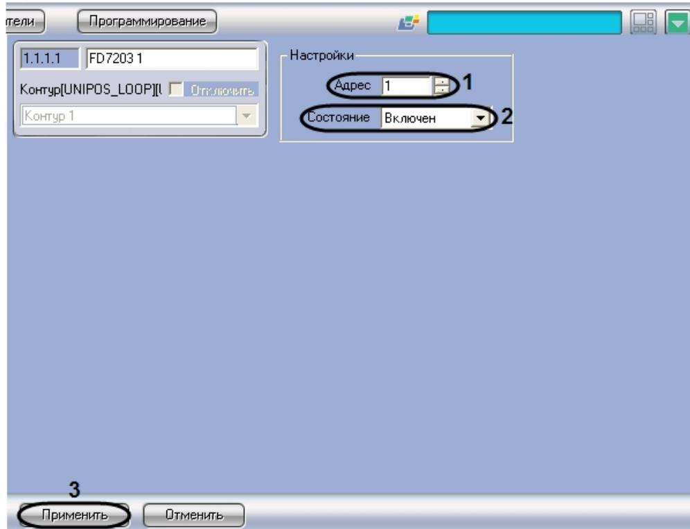
2. В поле **Адрес** ввести с помощью кнопок **вверх-вниз** адрес модуля *FD7203* в CAN-сети ОПС *Unipos* (1).
