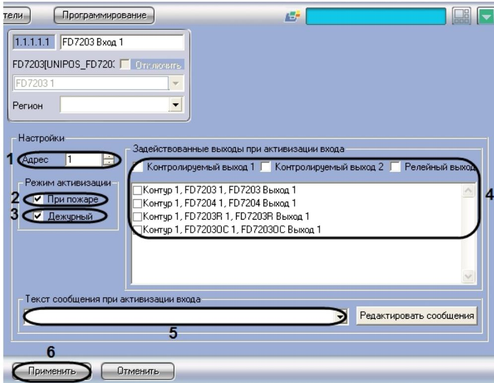
2. В поле **Адрес** ввести с помощью кнопок **вверх-вниз** адрес входа модуля *FD7203* (от 1 до 3) (1).
