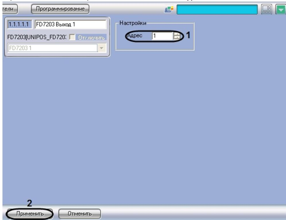
2. В поле со списком **Адрес** ввести адрес выхода модуля *FD7203* (**1**).
