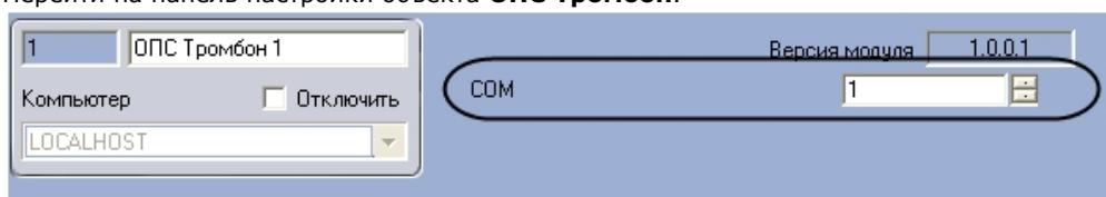
2. Указать СОМ-порт подключения системы к серверу с помощью кнопок **вверх-вниз**.
