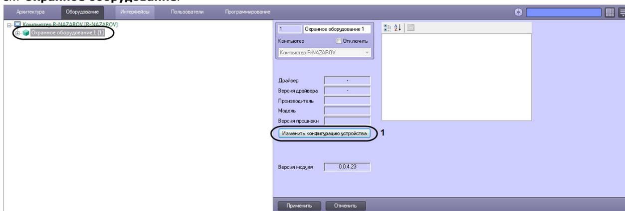
2. На панели настроек объекта **Охранное оборудование** нажать кнопку **Изменить конфигурацию устройства** (1).
