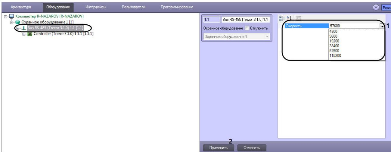
2. Указать для параметра **Скорость** (1) из выпадающего списка необходимую скорость (бит в секунду) обмена данными между СОМ-портом компьютера и устройством *Трезор*.
