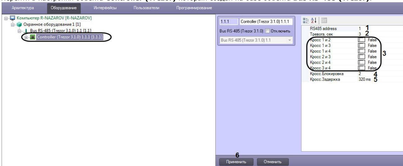
2. Указать для параметра **RS485 address** (1) адрес подключаемого контроллера, в пределах от 0 до 255 для идентификации различных контроллеров, подключенных по интерфейсу RS-485.
