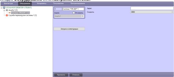
2. В поле **Адрес** указать номер СОМ-порта, к которому подключено устройство *Трезор*.
