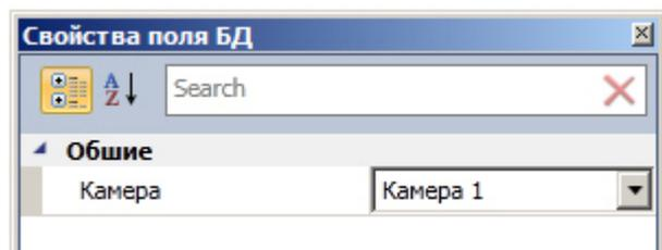
Из раскрывающегося списка **Камера** выбрать видеокамеру, с которой будет производиться отображение видеосигнала в созданное поле объекта.
