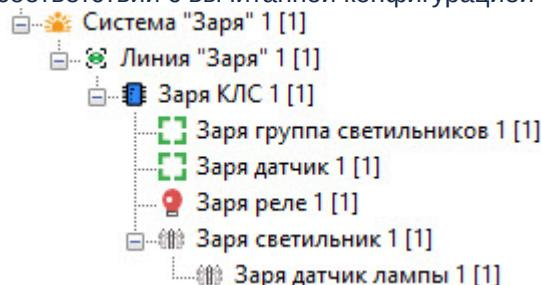
Конфигурирование головного объекта модуля *Система "Заря"* завершено.
