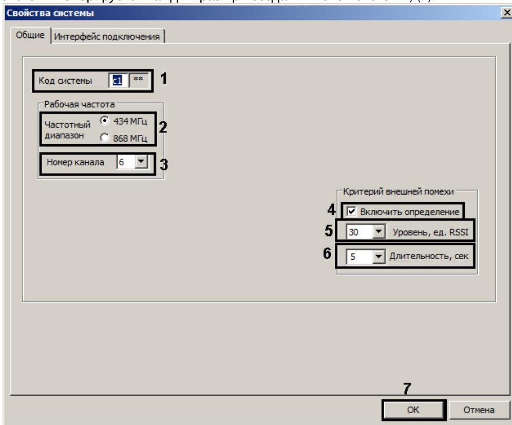
4. В поле **Частотный диапазон** следует установить переключатель в положение, соответствующее необходимой частоте (2).
