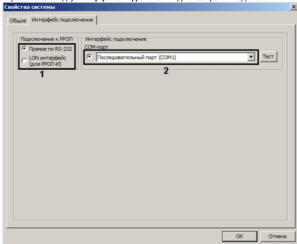
8. В поле **Подключение к РРОП** установить переключатель в положение, соответствующее необходимому типу подключения (1).
