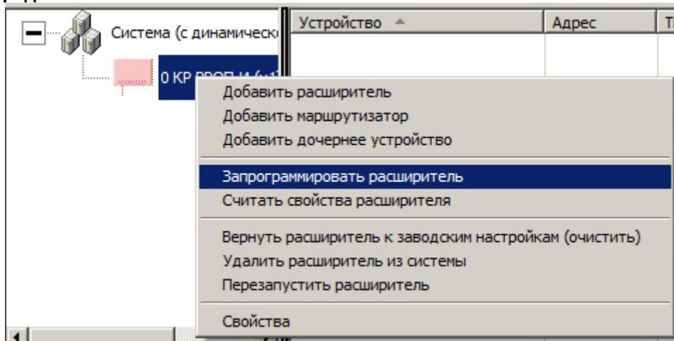
При корректном подключении радиорасширителя к ПК и выборе COM-порта появится окно **Прогресс программирования расширителя**.
